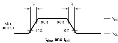
**FIGURE 2. Waveforms**
