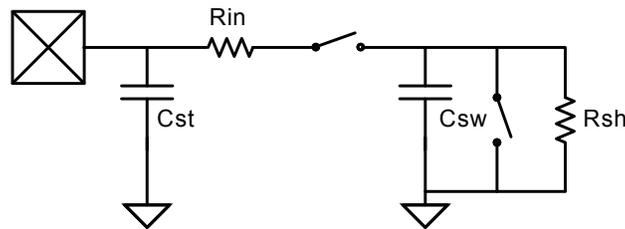
**Figure 2-42 • ADC Input Model**
