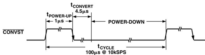
Figure 13. Automatic Power-Down
