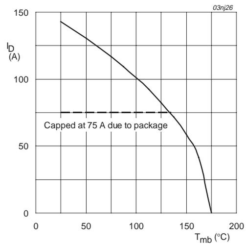
$V_{GS} \geq 4.5 V$
