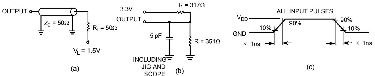
**2.5V I/O Test Load**
