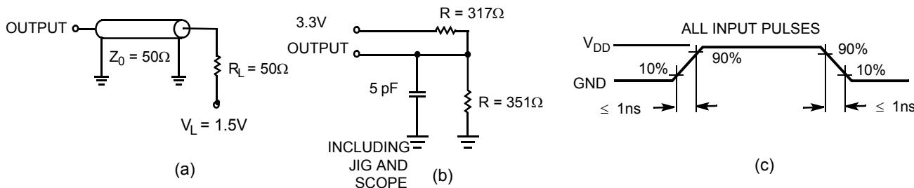
**2.5V I/O Test Load**
