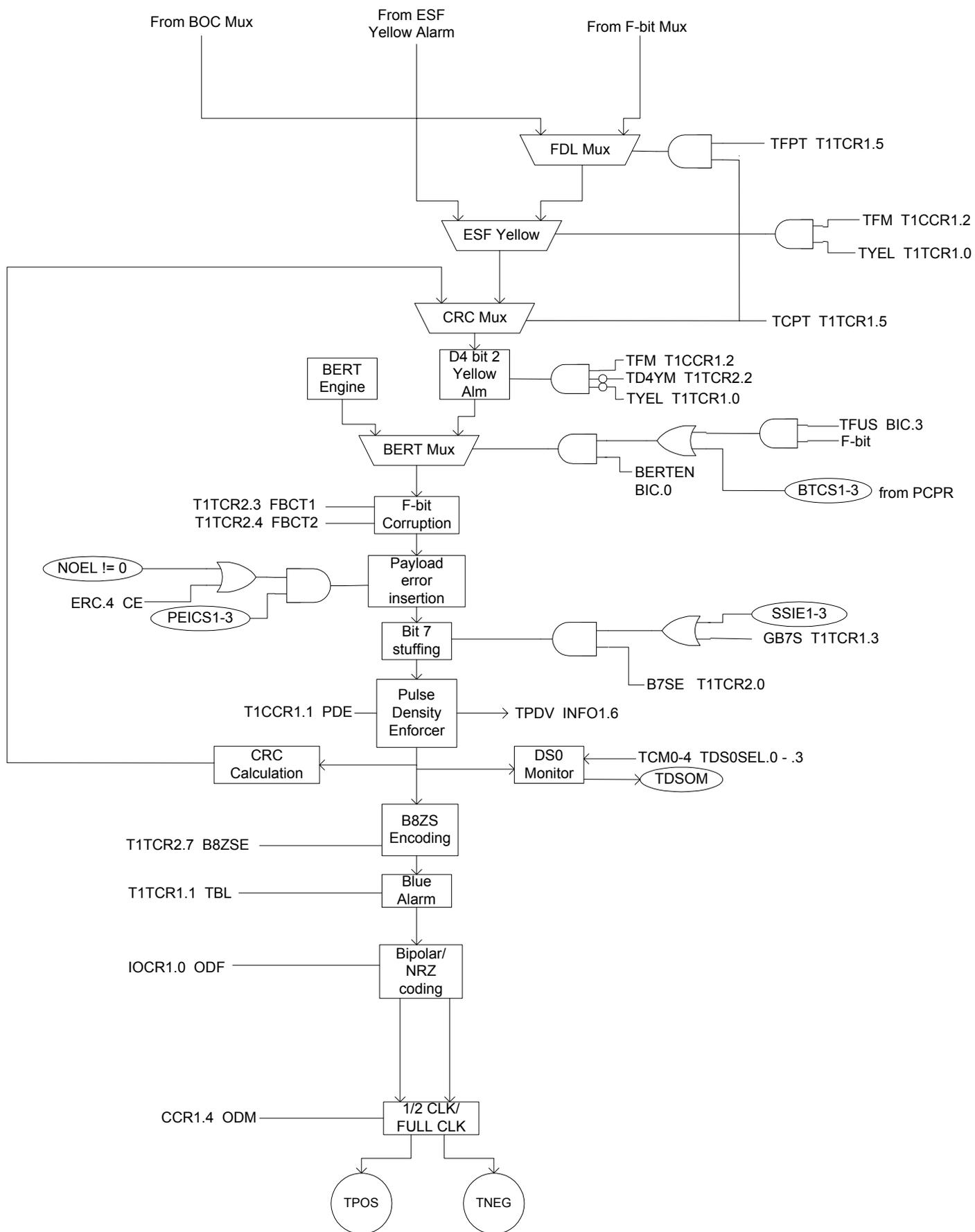
Figure 33-2. E1 Transmit Flow Diagram
