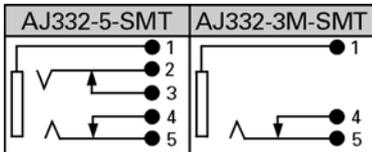
INPUT/OUTPUT CONNECTORS - EARPHONE JACKS
