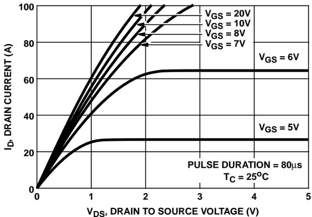
FIGURE 7. SATURATION CHARACTERISTICS
