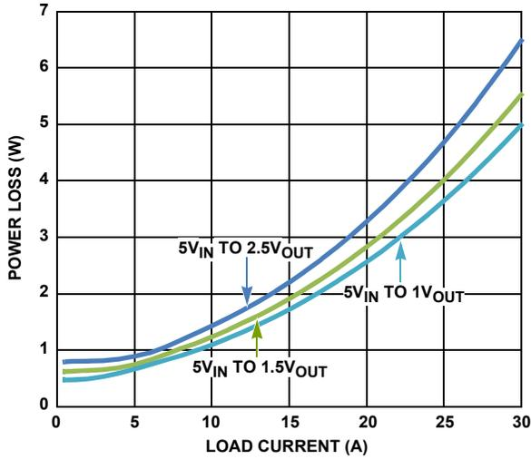
FIGURE 35. POWER LOSS CURVES OF 5V<sub>IN</sub>
