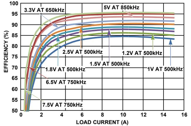
FIGURE 4. EFFICIENCY vs LOAD CURRENT (12V<sub>IN</sub>)
