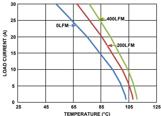
FIGURE 42. DERATING CURVE 12V TO 2.5V
