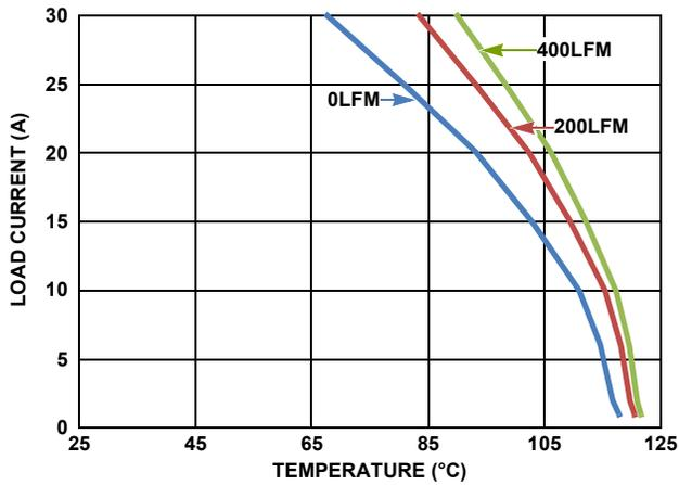
FIGURE 39. DERATING CURVE 5V TO 1.5V
