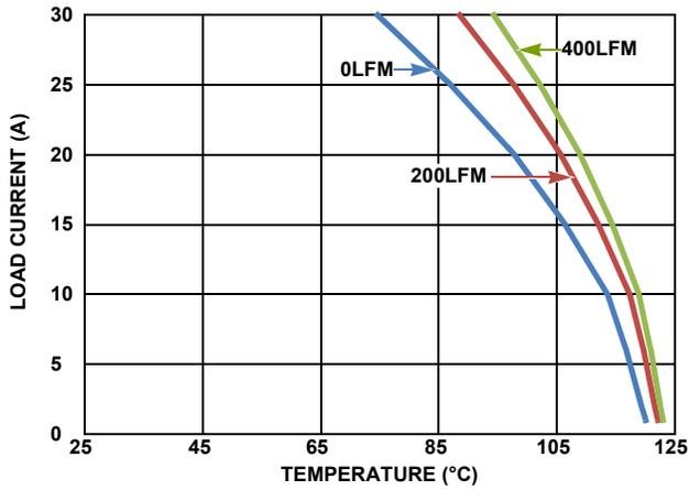
FIGURE 37. DERATING CURVE 5V TO 1V
