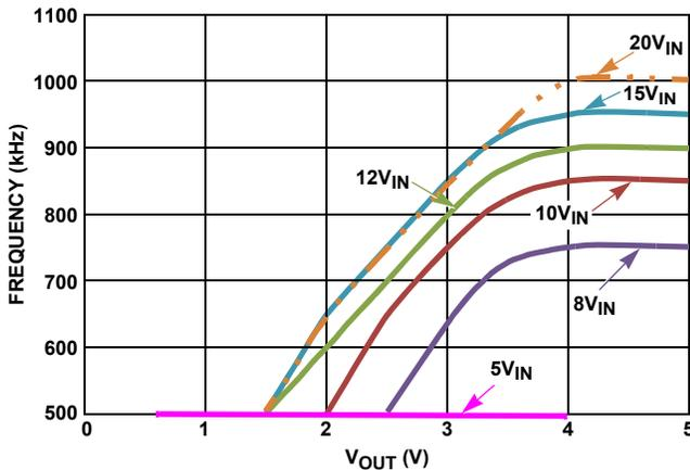
**FIGURE 27. RECOMMENDED FREQUENCY vs V<sub>IN</sub> AT V<sub>OUT</sub>**
