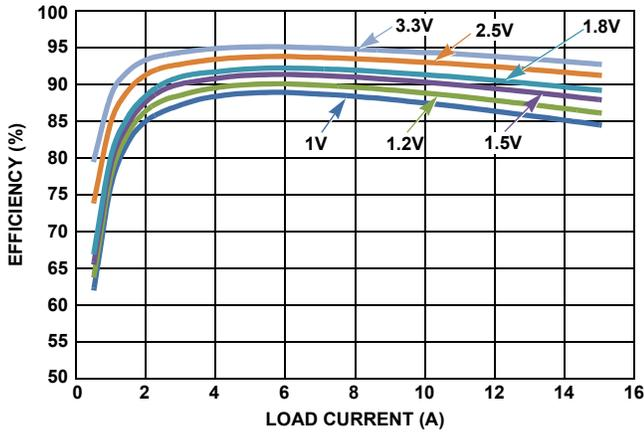
FIGURE 3. EFFICIENCY vs LOAD CURRENT (5V<sub>IN</sub> AT 500kHz)
