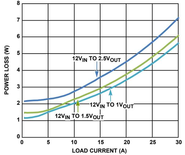
FIGURE 36. POWER LOSS CURVES OF 12V<sub>IN</sub>
