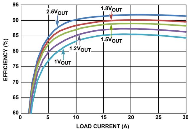
FIGURE 7. EFFICIENCY vs LOAD CURRENT (PARALLEL SINGLE OUTPUT, AS SHOWN IN [Figure 19](#) AT 12V<sub>IN</sub>/500kHz)
