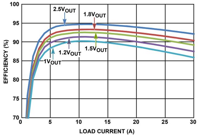
FIGURE 6. EFFICIENCY vs LOAD CURRENT (PARALLEL SINGLE OUTPUT, AS SHOWN IN [Figure 19](#) AT 5V<sub>IN</sub>/500kHz)
