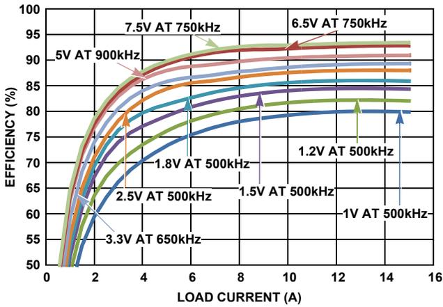
FIGURE 5. EFFICIENCY vs LOAD CURRENT (20V<sub>IN</sub>)
