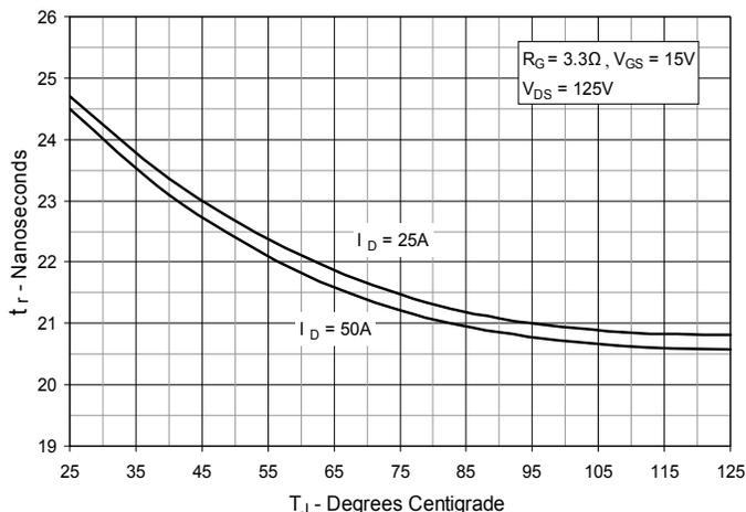
**Fig. 14. Resistive Turn-on
