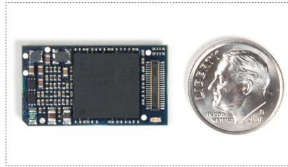
OMAP35x TORPEDO SYSTEM ON MODULE
