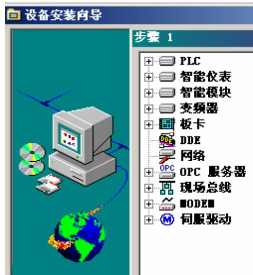
选择 PLC-莫迪康(Modicon)-Modbus(RTU 协议)-串口
