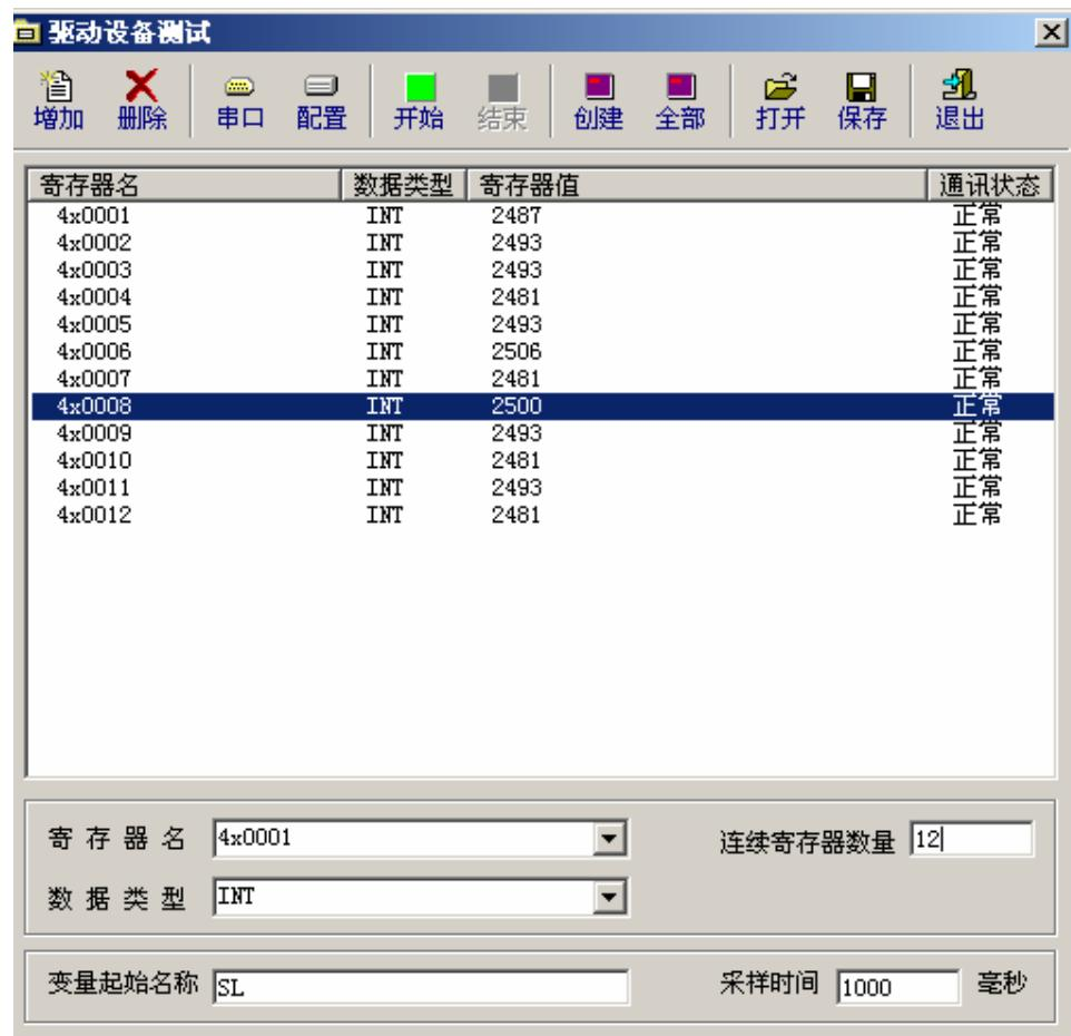
寄存器名为 4x0001, 连续寄存器数量为 12 (模块实际接的传感器数)，变量起始名称可以任意写，设置好后，点击增加，即会出现上图所示的寄存器列表，点击【开始】命令，就可以对模块数据进行采集测试，此时，寄存器值都可以正常显示。比如值为:2487 表明实际温度为 24.87, 即显示值除以 100 即为真实值。寄存器测试正常后即可在工程中进行调用显示，在此不作介绍。
