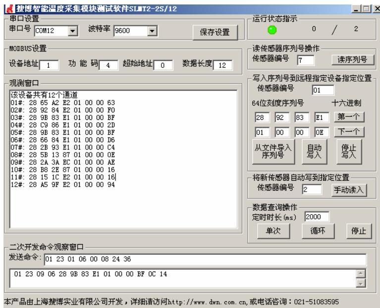
打开上面按固定格式编号的序列号文件后，即将序列号写入到模块，观测窗口数据应如下图格式。
