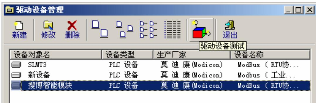
如上图所示，搜博智能模块是上新建的设备，双击【驱动设备测试】命令按钮即可对设备进行联机测试。
