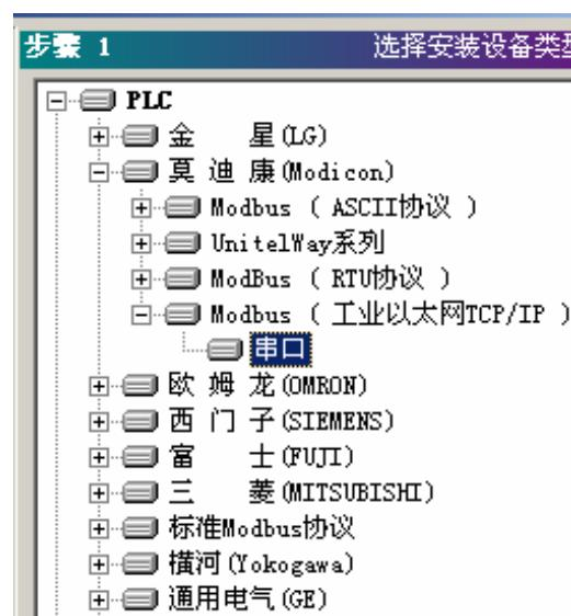
将串口设置成与模块连接的端口号，并将设备地址设置成 1（模块默认），如下图所示：
