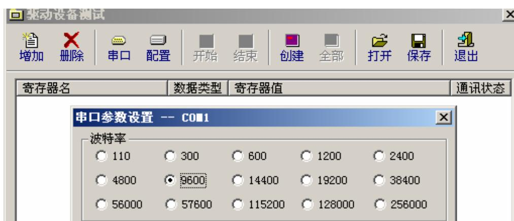
点击【串口】图标可以调整波特率，本模块的默认波特率为 9600，修改后保存后，可按如下图标显示增加寄出器变量：
