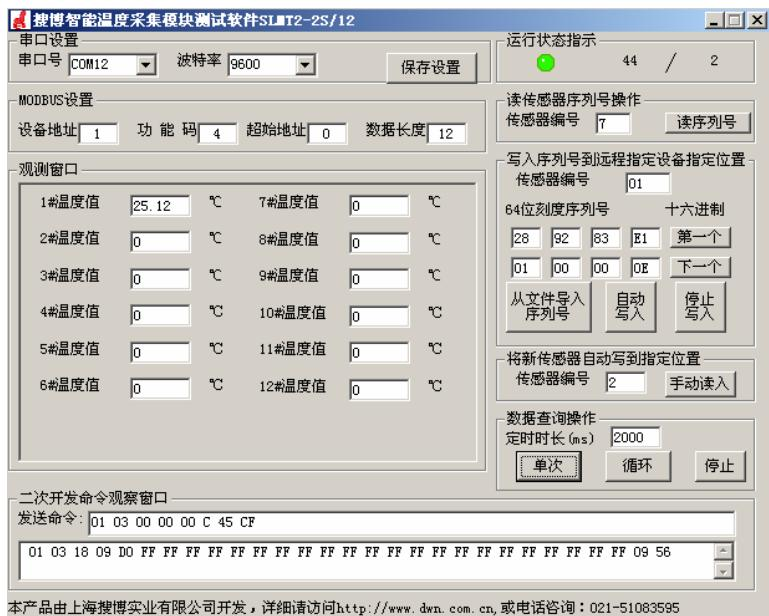
当现在 0 数据时，表明传感器没有接入或者传感器没有写入到模块，可以按照 1-3 步骤重新操作。直接有正常数据显示。
