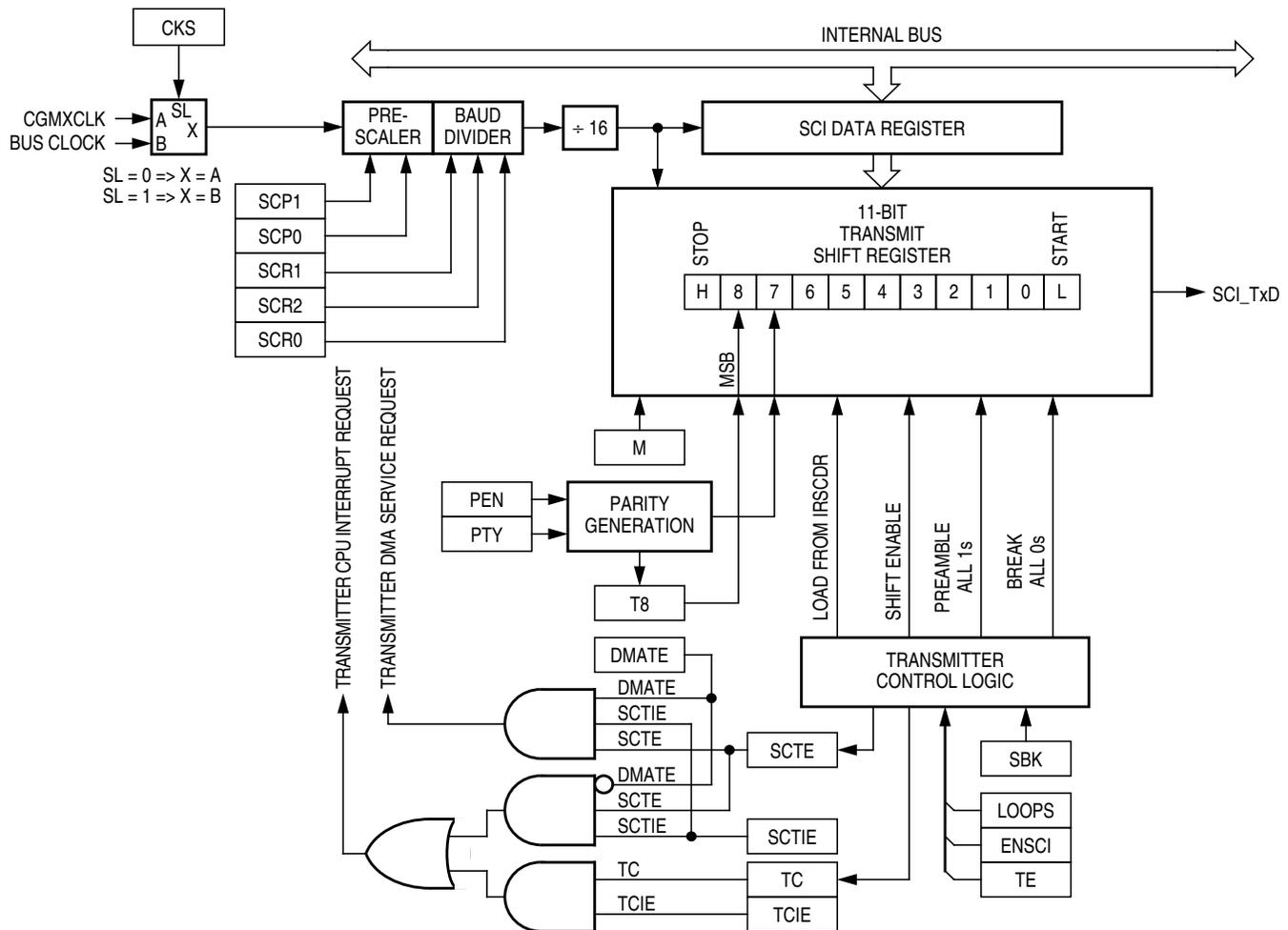
Figure 12-7. SCI Transmitter
