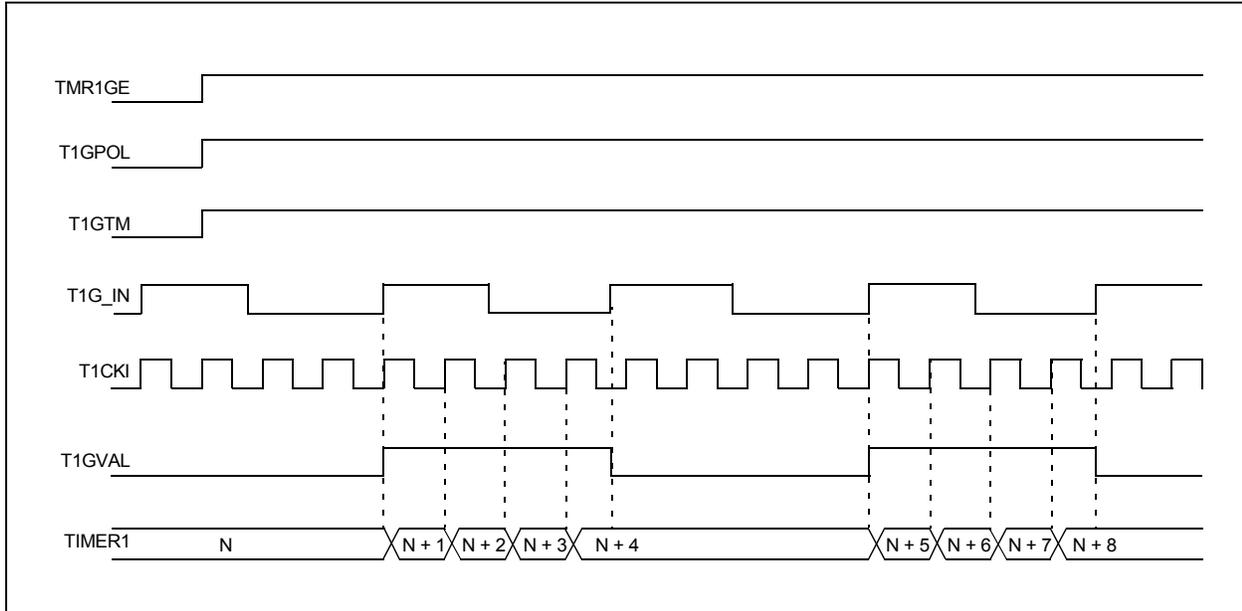
**FIGURE 21-5: TIMER1 GATE SINGLE-PULSE MODE**
