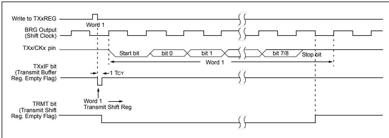
**FIGURE 25-4: ASYNCHRONOUS TRANSMISSION (BACK-TO-BACK)**
