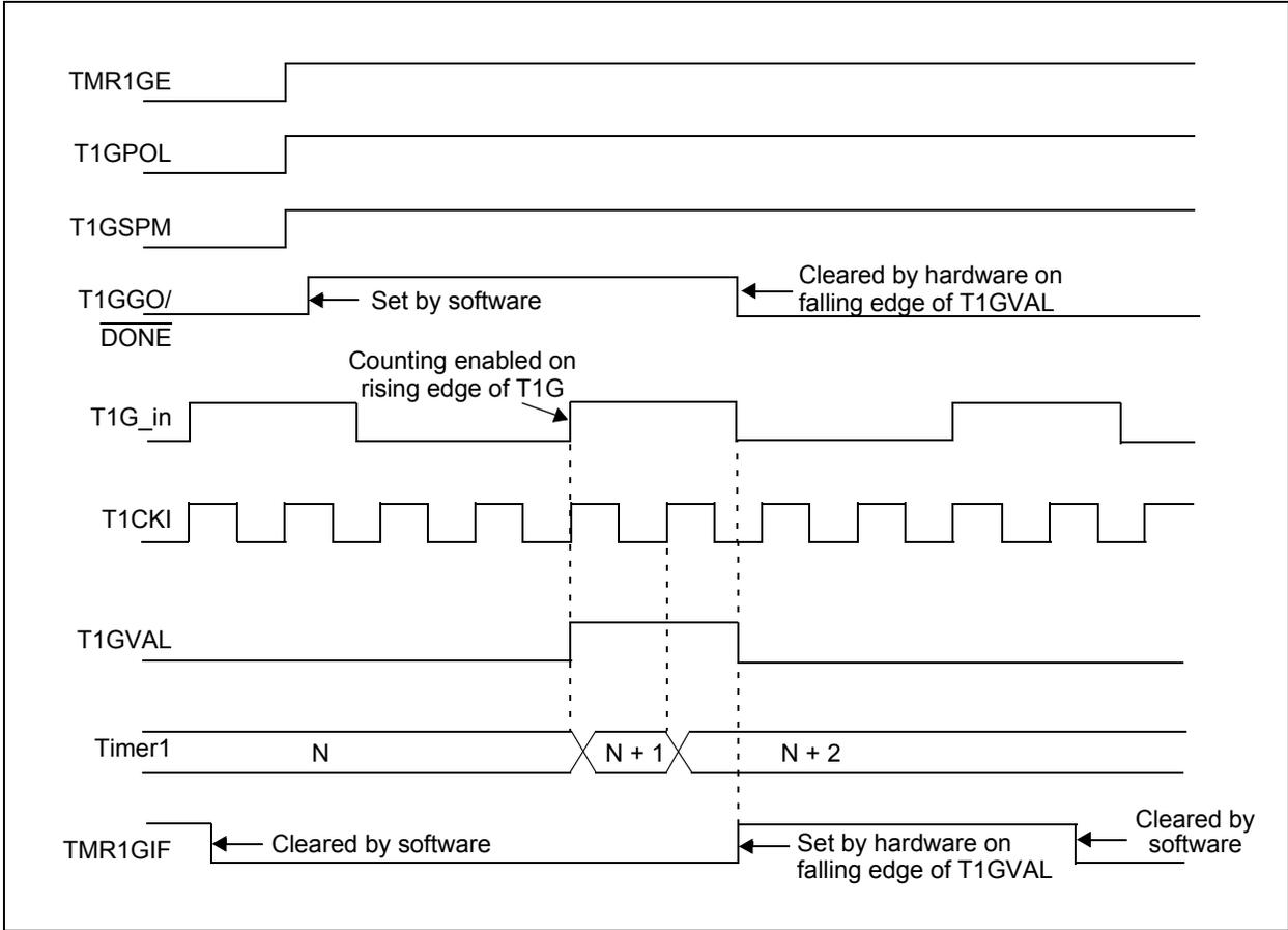
FIGURE 22-6: TIMER1 GATE SINGLE-PULSE AND TOGGLE COMBINED MODE
