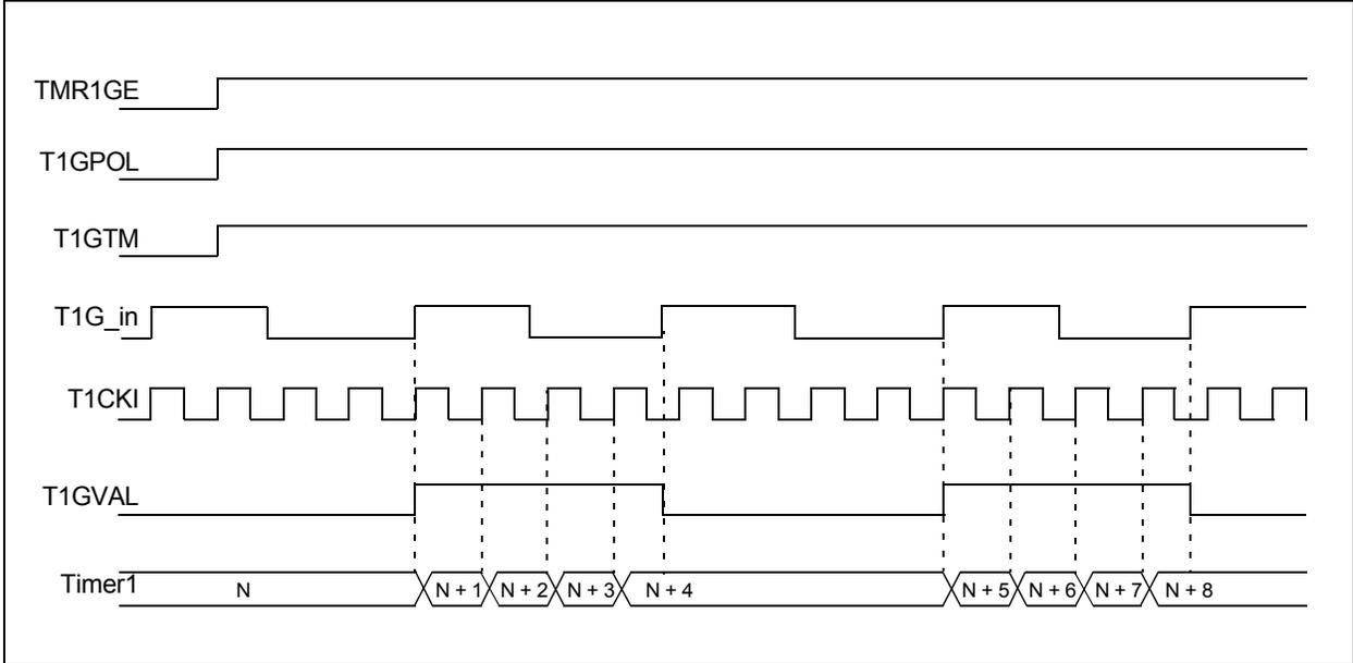
FIGURE 22-5: TIMER1 GATE SINGLE-PULSE MODE
