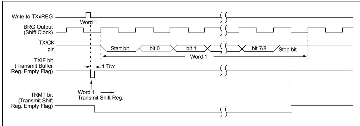
**FIGURE 25-4: ASYNCHRONOUS TRANSMISSION (BACK-TO-BACK)**
