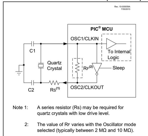
**FIGURE 5-4: CERAMIC RESONATOR OPERATION (HS MODE)**
