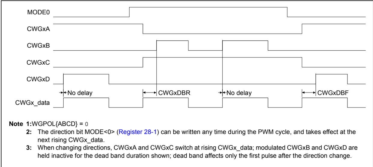
**FIGURE 28-9: CWG HALF-BRIDGE MODE OPERATION**
