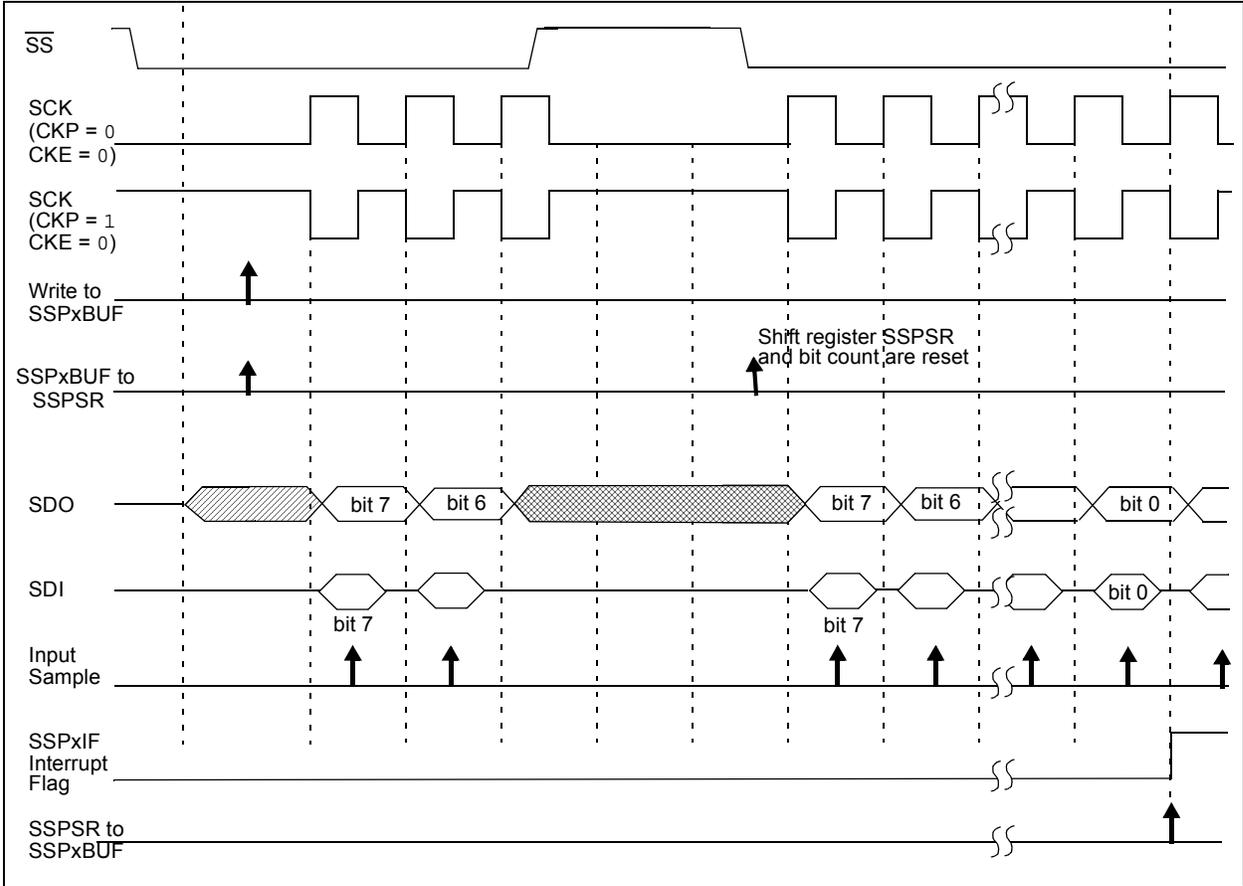
FIGURE 24-9: SPI MODE WAVEFORM (SLAVE MODE WITH CKE = 0)
