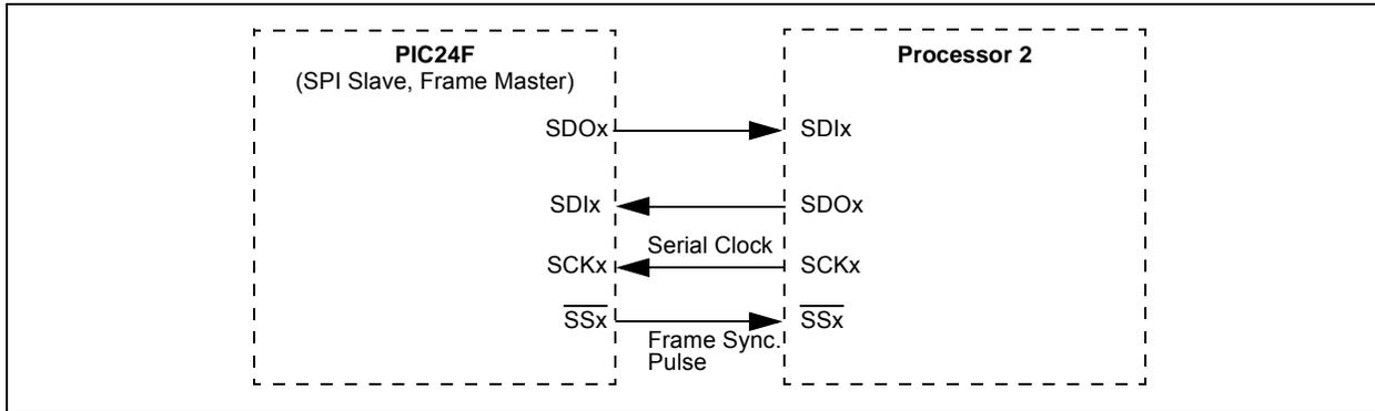
**FIGURE 16-8: SPIx SLAVE, FRAME SLAVE CONNECTION DIAGRAM**
