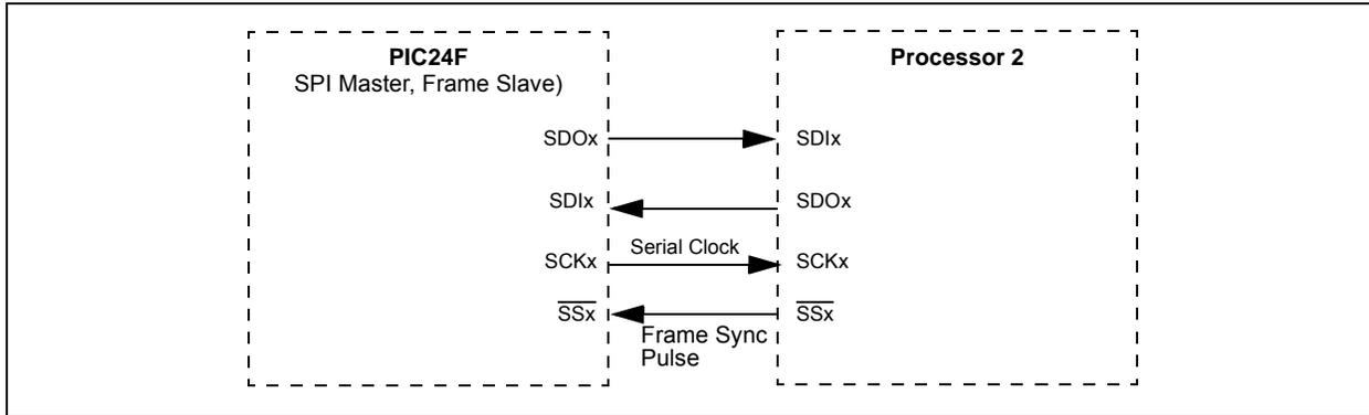
**FIGURE 16-7: SPIx SLAVE, FRAME MASTER CONNECTION DIAGRAM**
