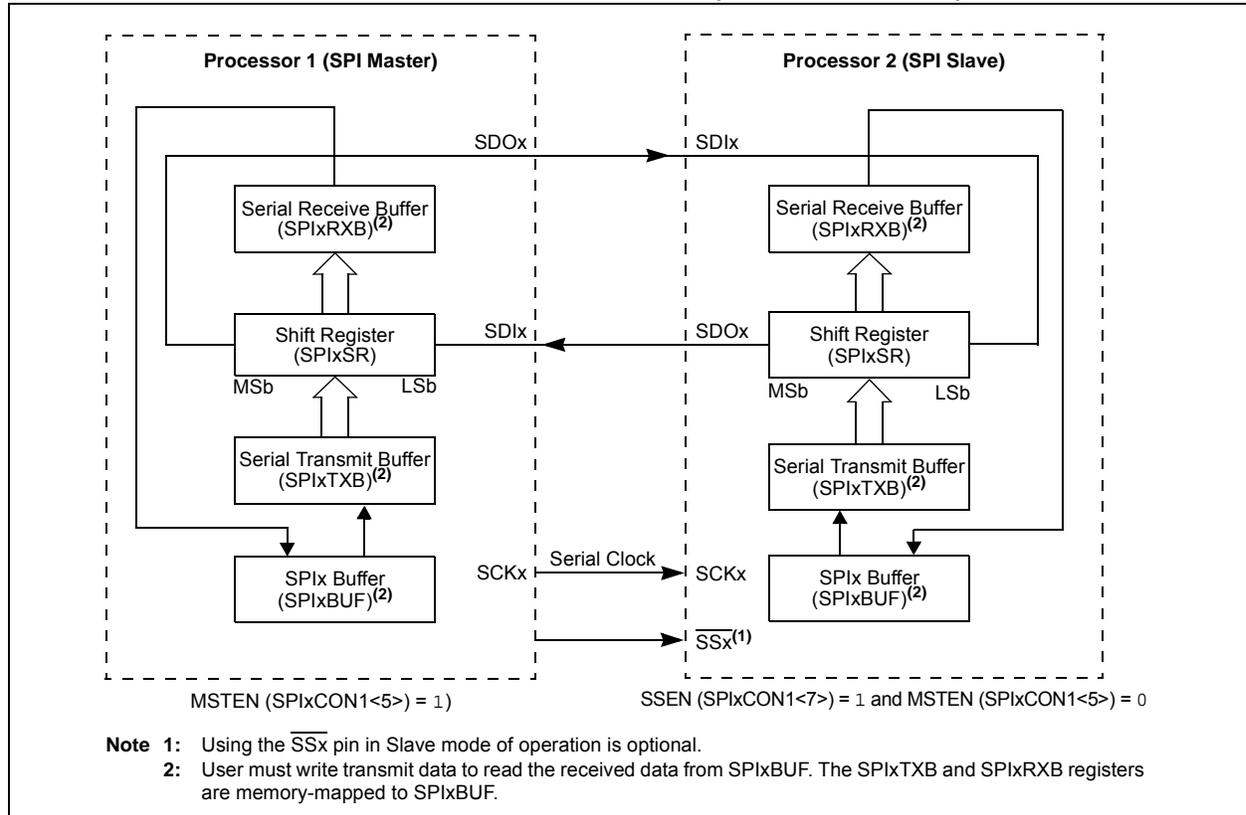
**FIGURE 16-4: SPIx MASTER/SLAVE CONNECTION (ENHANCED BUFFER MODES)**
