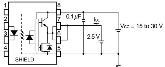
Fig. 3 V<sub>OH</sub> Test Circuit
