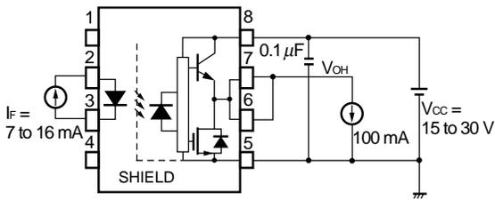
Fig. 4 V<sub>OL</sub> Test Circuit
