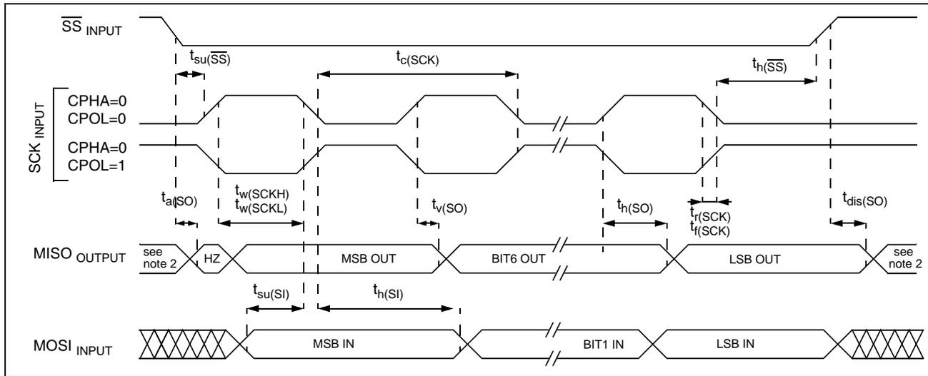
Figure 95. SPI Master Timing Diagram <sup>1)</sup>
