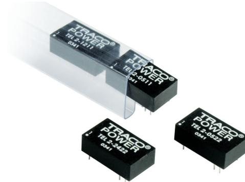
Die TEL-2 Serie, bestehend aus 28 verschiedenen Modellen, sind isolierte 2 Watt DC/DC-Konverter in einem niedrigen DIL-16 Gehäuse. Mit dem sehr kleinen Oberflächenbedarf von 3.25 cm<sup>2</sup> auf der Printkarte bieten sie, ohne externe Komponenten einen kompletten DC/DC-Konverter. Der weite Eingangsbereich und die genau regulierten Ausgänge machen diese Serie für eine Vielzahl von kostenkritischen Anwendungen in Industrie- und Elektronikbereichen interessant.
