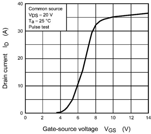
**Fig. 8.3  $I_D - V_{GS}$**
