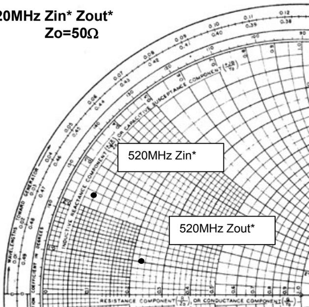
$V_{dd}=7.2V$ ,  $I_{dq}=100mA$  ( $V_{gg}$  adj.),  $P_{in}=0.03W$
