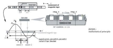
sensor output 1 (chip 1):  $V_1 = H_{max} \cdot cos (w \cdot 2\Pi/\Lambda) = H_{max} \cdot sin ((w \cdot 2\Pi/\Lambda) + \Pi/2)$
