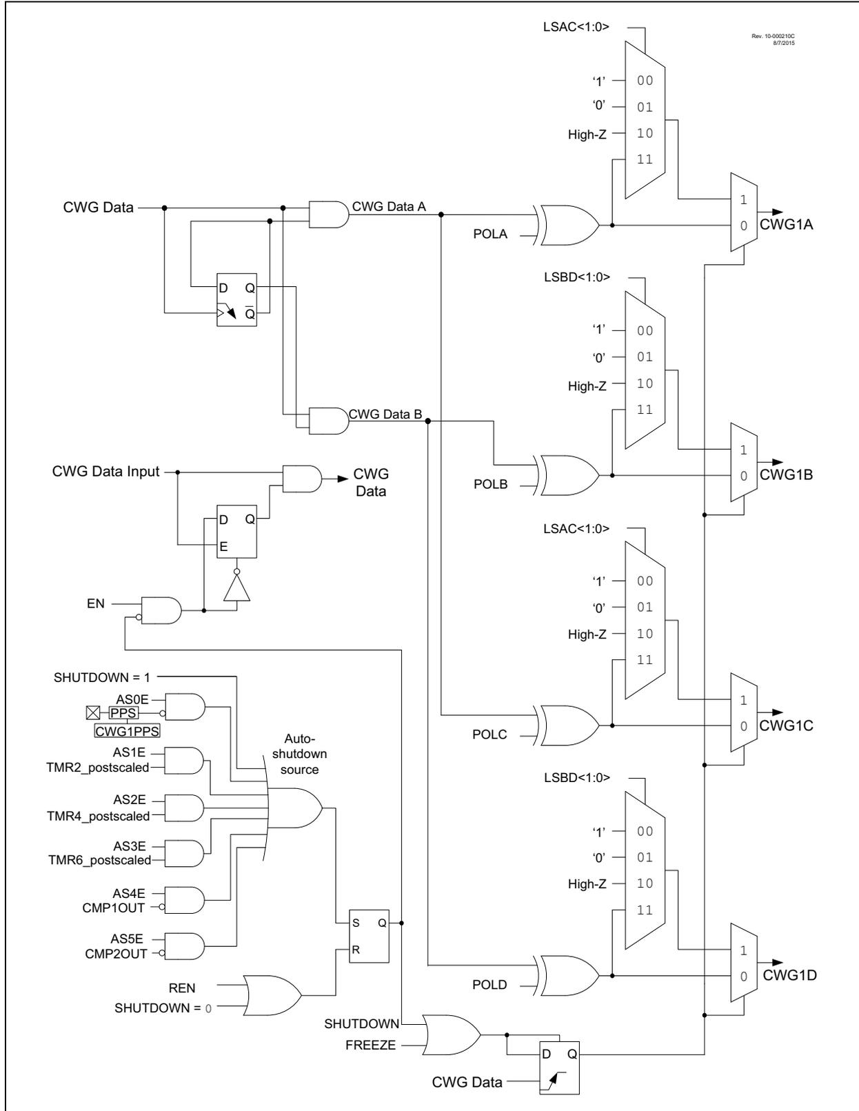
**FIGURE 24-4: CWG1 PUSH-PULL MODE OPERATION**
