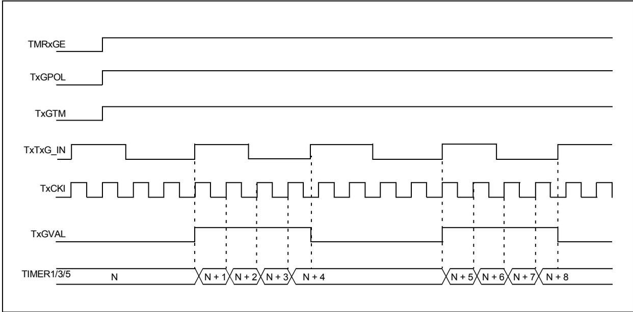
**FIGURE 19-6: TIMER1/3/5 GATE SINGLE-PULSE MODE**
