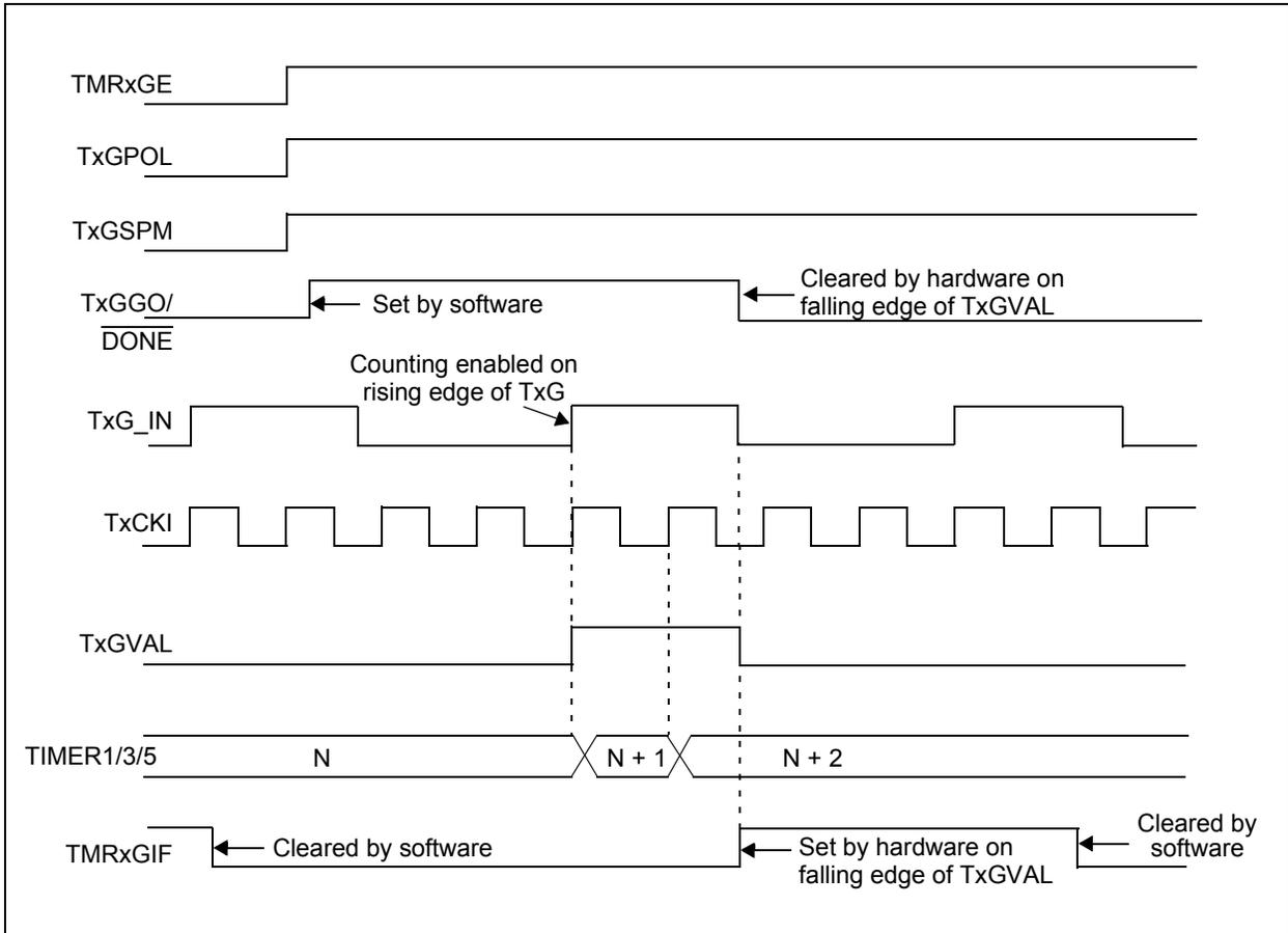
**FIGURE 19-7: TIMER1/3/5 GATE SINGLE-PULSE AND TOGGLE COMBINED MODE**
