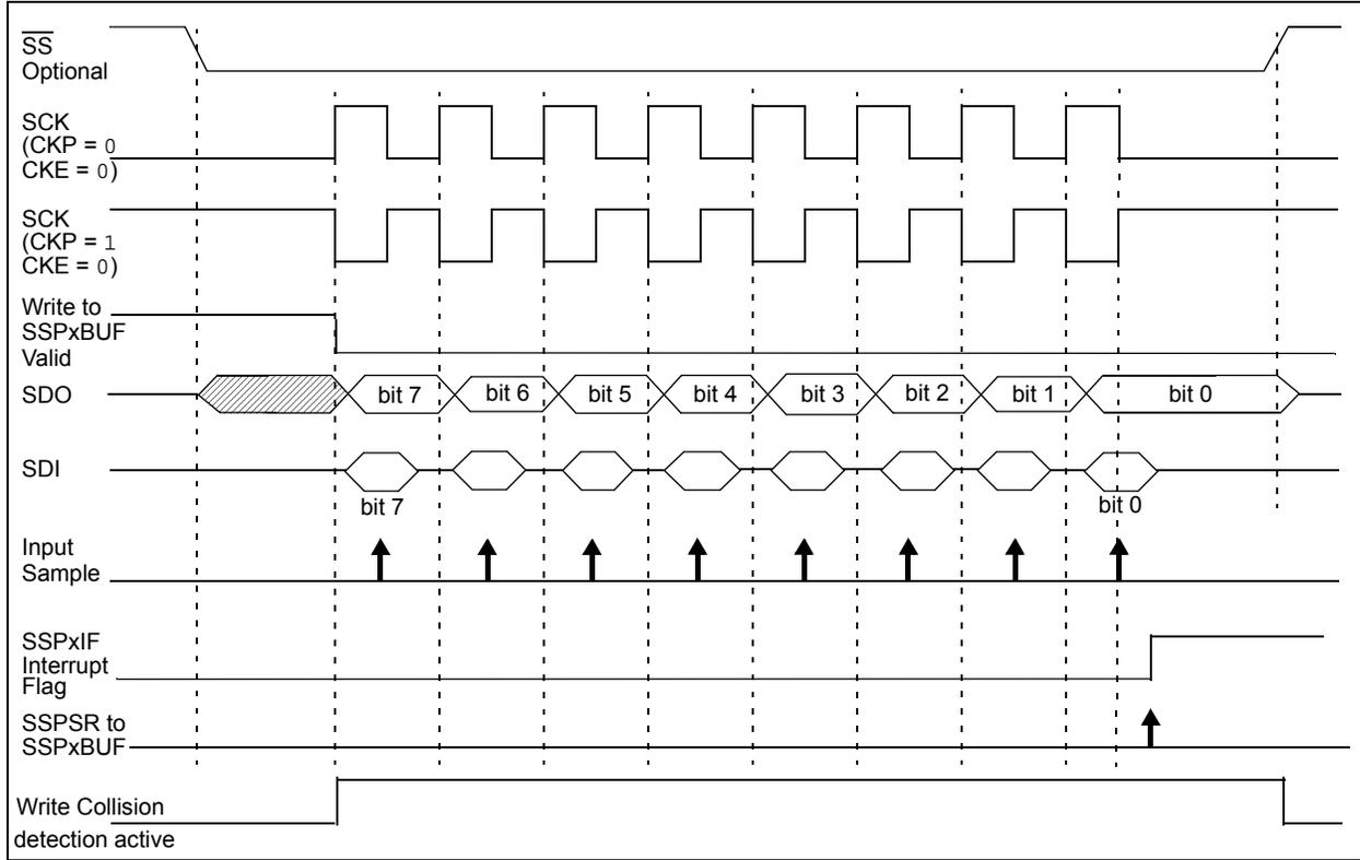
**FIGURE 26-8: SPI MODE WAVEFORM (SLAVE MODE WITH CKE = 1)**
