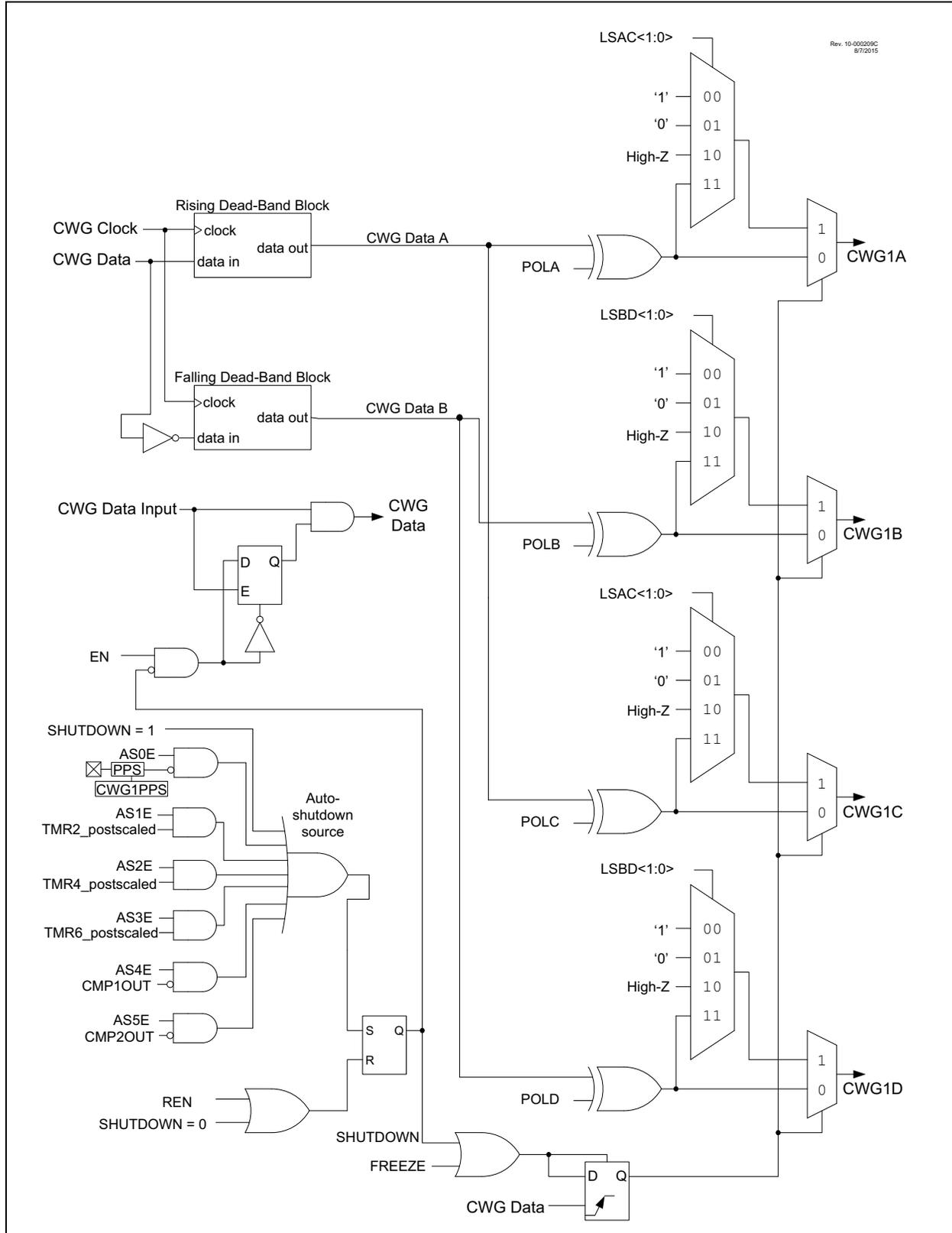
**FIGURE 24-2: CWG1 HALF-BRIDGE MODE OPERATION**
