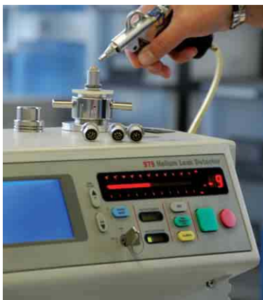
Vacuumtest with leakdetector Vakuumtest mit Leakdetektor
