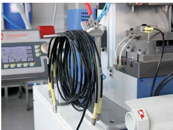
Cable overmold technology Umspritzen für Kabelzug- entlastungen
