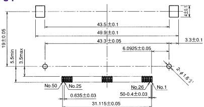
●Eject button : None ●Offset : 2.2 mm
