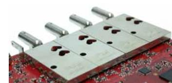
细致入微的前台设计与屏蔽可减少噪音、串扰与谐波失真。凭借多年的示波器制造经验，我们能够提高脉冲响应速度以及带宽平滑度。
