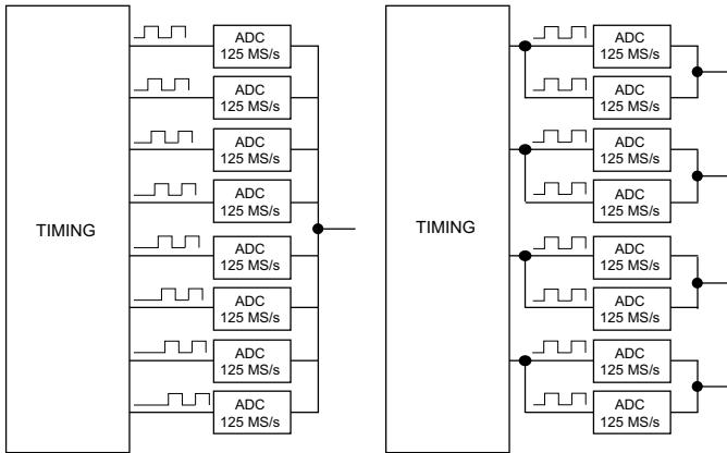
在并行模式，多个 ADC 在每条通道内进行同相采样，使每条通道 (70 dB SFDR) 内的分辨率在 125 MS/s 时提高至 14 位（参看示意图）。如果仅需两条通道，分辨率能够提高至 15 位，在单通道模式，所有 ADC 相互结合，可在采样分辨率为 62.5MS/s 时提供 16 位模式。
