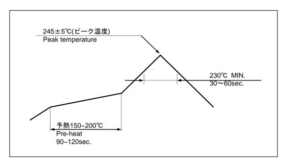
【\*. 推奨温度プロファイル Recommended Reflow Profile】
