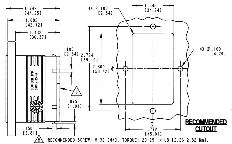
MATERIAL - HOUSING: PLASTIC (BLACK); GROMMET: RUBBER; INSERT: STEEL.
