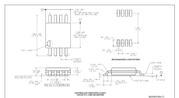
8 Lead Mini SOIC (MM) NS Package Number MUA08A
