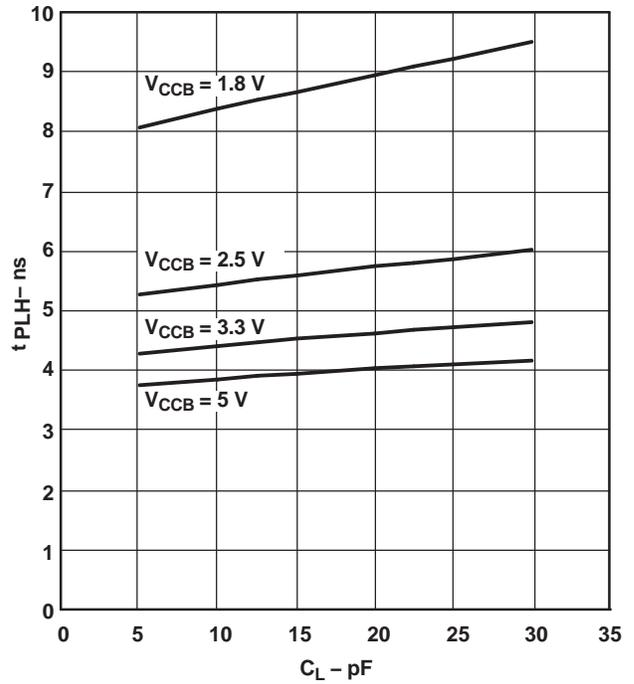
TYPICAL PROPAGATION DELAY (B to A) vs LOAD CAPACITANCE
