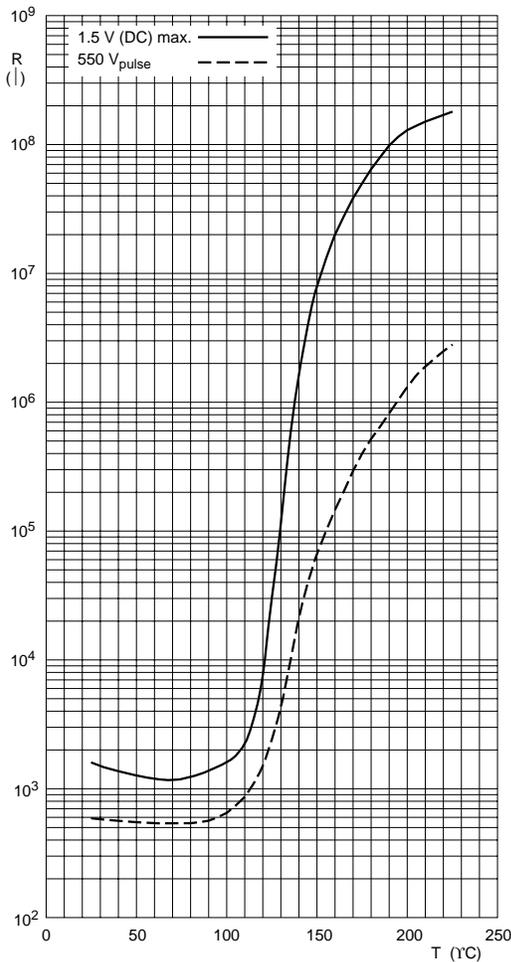
**TYPICAL RESISTANCE/TEMPERATURE CHARACTERISTIC** for 2322 661 93113.
