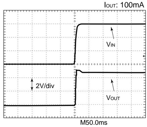
((R1210N302C)) ( $V_{IN}$ : 0V→1.5V)
