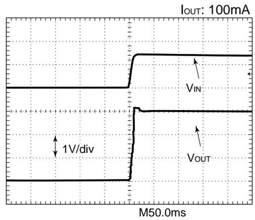
((R1210N302D)) ( $V_{IN}$ : 0V→1.5V)
