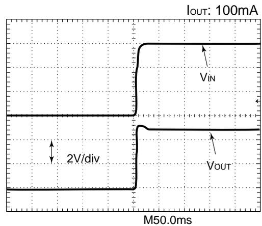
((R1210N502D)) ( $V_{IN}$ : 0V→3.0V)
