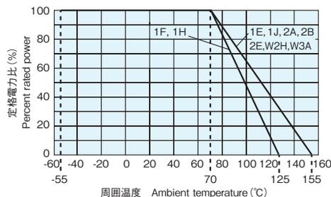
周囲温度70℃以上で使用される場合は、上図に示す負荷軽減曲線に従って、定格電力を軽減して御使用下さい。
