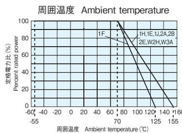
周囲温度70℃以上で使用される場合は、上図に示す負荷軽減曲線に従って、定格電力を軽減して御使用ください。
