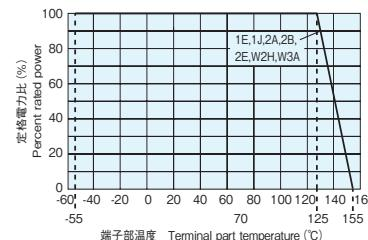
周囲温度70°C以上で使用される場合は、上図に示す負荷軽減曲線に従って、定格電力を軽減してご使用ください。
