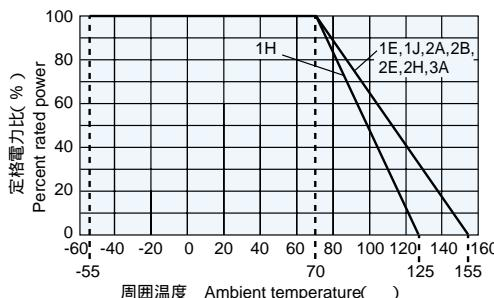
周囲温度70°C以上で使用される場合は、上図に示す負荷軽減曲線に従って、定格電力を軽減して御使用下さい。
