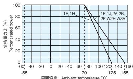
周囲温度70°C以上で使用される場合は、上図に示す負荷軽減曲線に従って、定格電力を軽減して御使用ください。
