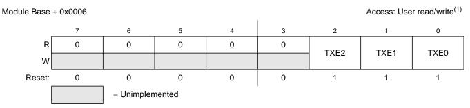
Figure 14-10. MSCAN Transmitter Flag Register (CANTFLG)
