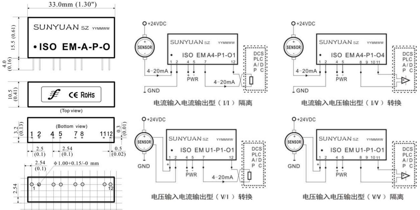
备注: 建议用户设计 PCB 板时产品封装外形尺寸 (长/宽/高) 均按上图所标注尺寸的+0.5mm/-0mm 设计。
