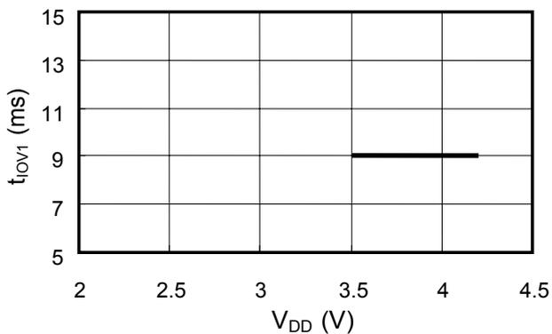
过电流2检测延迟时间—电源电压特性
