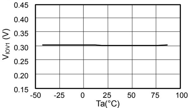
过电流 2 检测电压—温度特性
