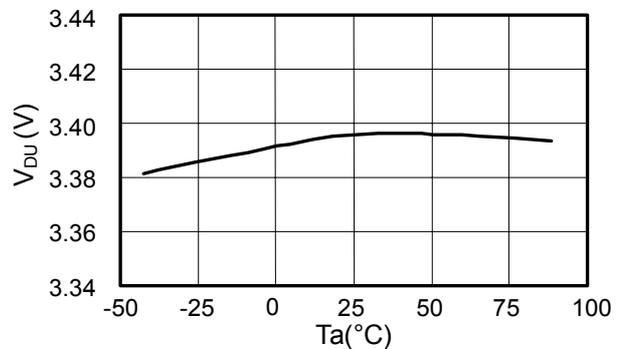
过电流 1 检测电压—温度特性
