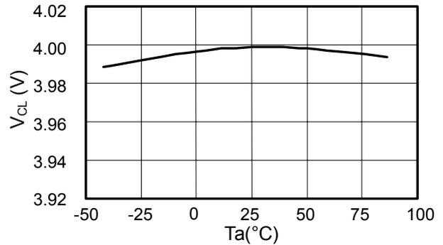
过放电检测电压—温度特性
