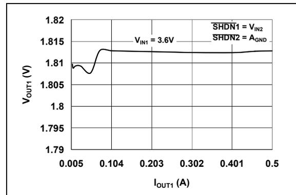
**FIGURE 2-12:**  $V_{OUT1}$  vs.  $I_{OUT1}$  ( $V_{OUT1} = 1.8\text{V}$ ).
