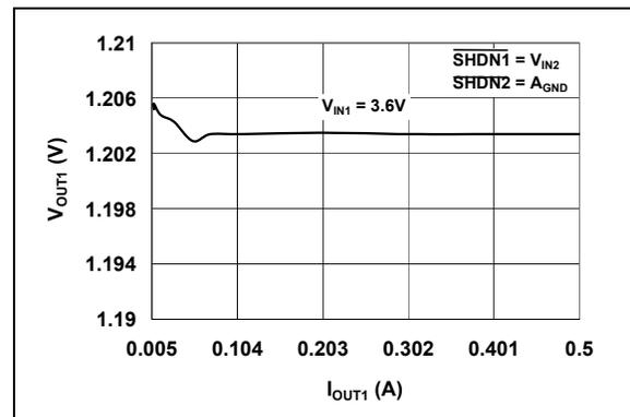
**FIGURE 2-11:**  $V_{OUT1}$  vs.  $I_{OUT1}$  ( $V_{OUT1} = 1.2\text{V}$ ).
