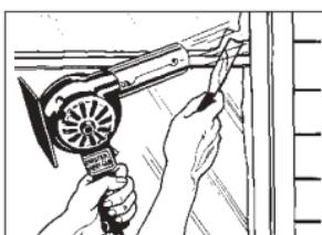
Para quitar la masilla de una ventana rota, con mucho cuidado, primeramente retire los cristales rotos. Para quitar la masilla de una ventana intacta, no dirija la corriente de aire caliente contra el cristal para evitar su cuarteadura debido al choque térmico. Es conveniente proteger el cristal del aire caliente usando una espátula grande. Con un movimiento hacia adelante y hacia atrás, dirija la corriente de aire caliente hacia la masilla hasta que se ablande. Quite la masilla con la espátula.
