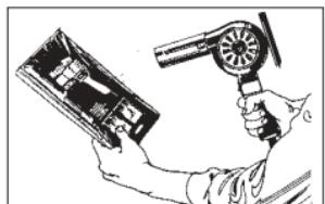
Después que la envoltura termoencogible se ha sellado alrededor de un producto, haga un pequeño orificio en la misma para permitir el escape del aire. Después dirija la corriente de aire caliente hacia el paquete efectuando un movimiento hacia adelante y hacia atrás por todo el paquete hasta que la envoltura se haya encogido de manera uniforme.
