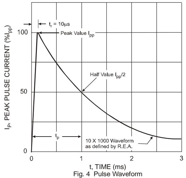
Fig. 4 Pulse Waveform
