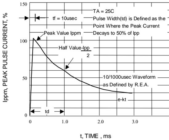
Fig. 3-PULSE WAVEFORM
