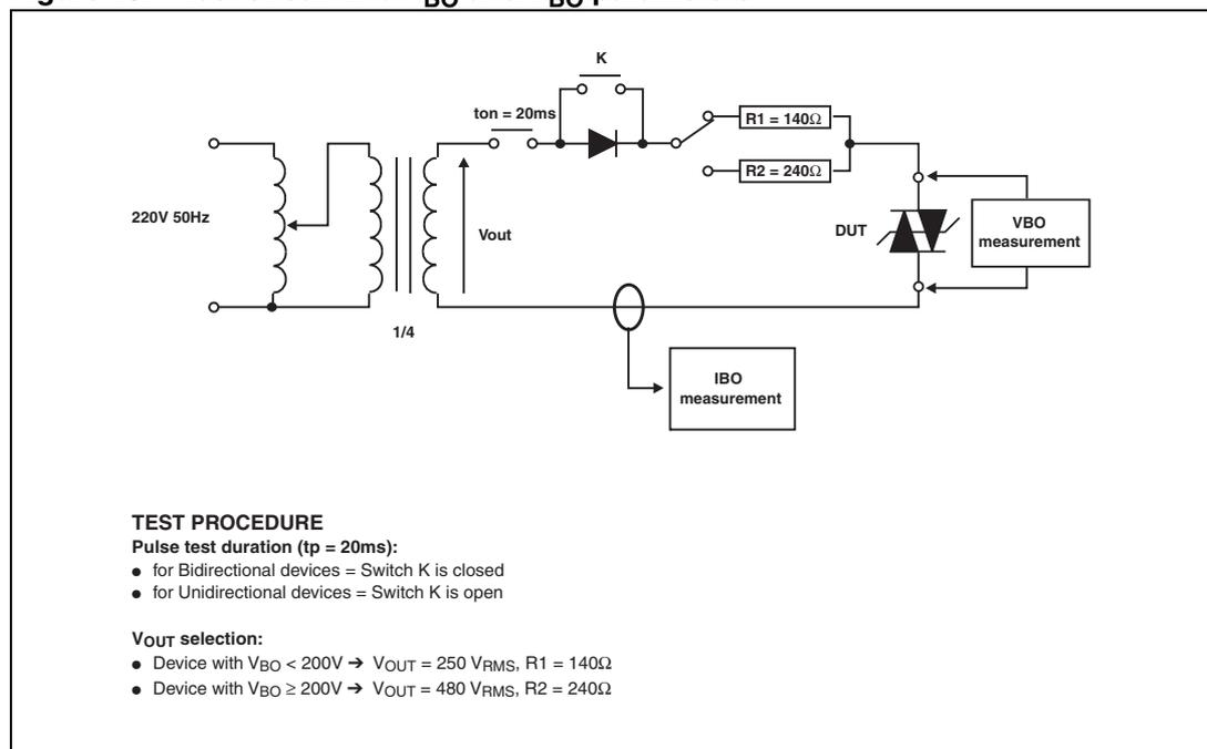
Figure 17. Test circuit 3 for dynamic  $I_H$  parameter
