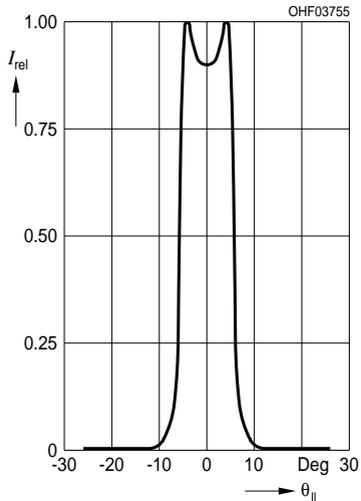
**Far-Field Distribution Perpendicular to pn-Junction**<sup>3)</sup> page 8**Fernfeldverteilung senkrecht zum pn-Übergang**<sup>3)</sup> Seite 8 $I_{\text{rel}} = f(\Theta_{\perp}), T_A = 25\text{ °C}, P_{\text{opt}} = 75\text{ W}$
