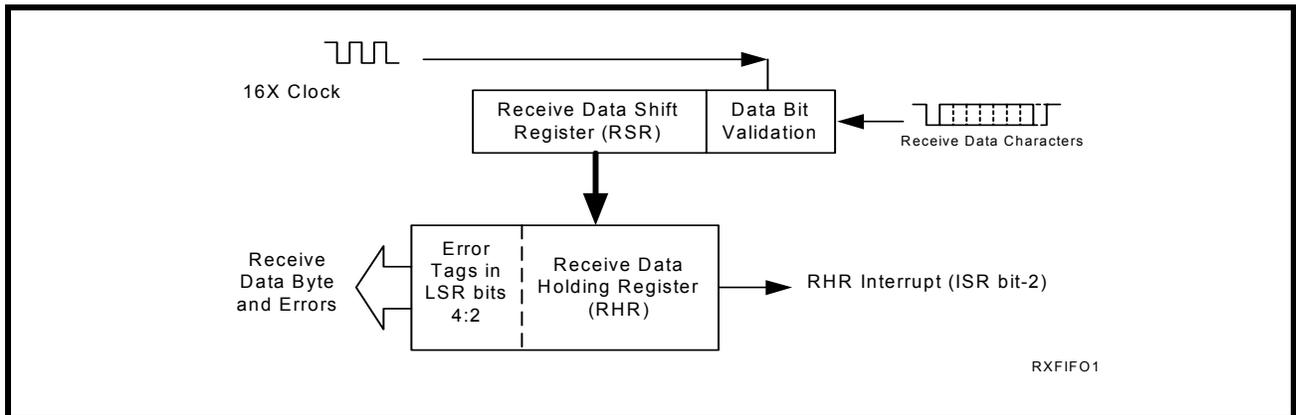
FIGURE 11. RECEIVER OPERATION IN FIFO AND AUTO RTS FLOW CONTROL MODE
