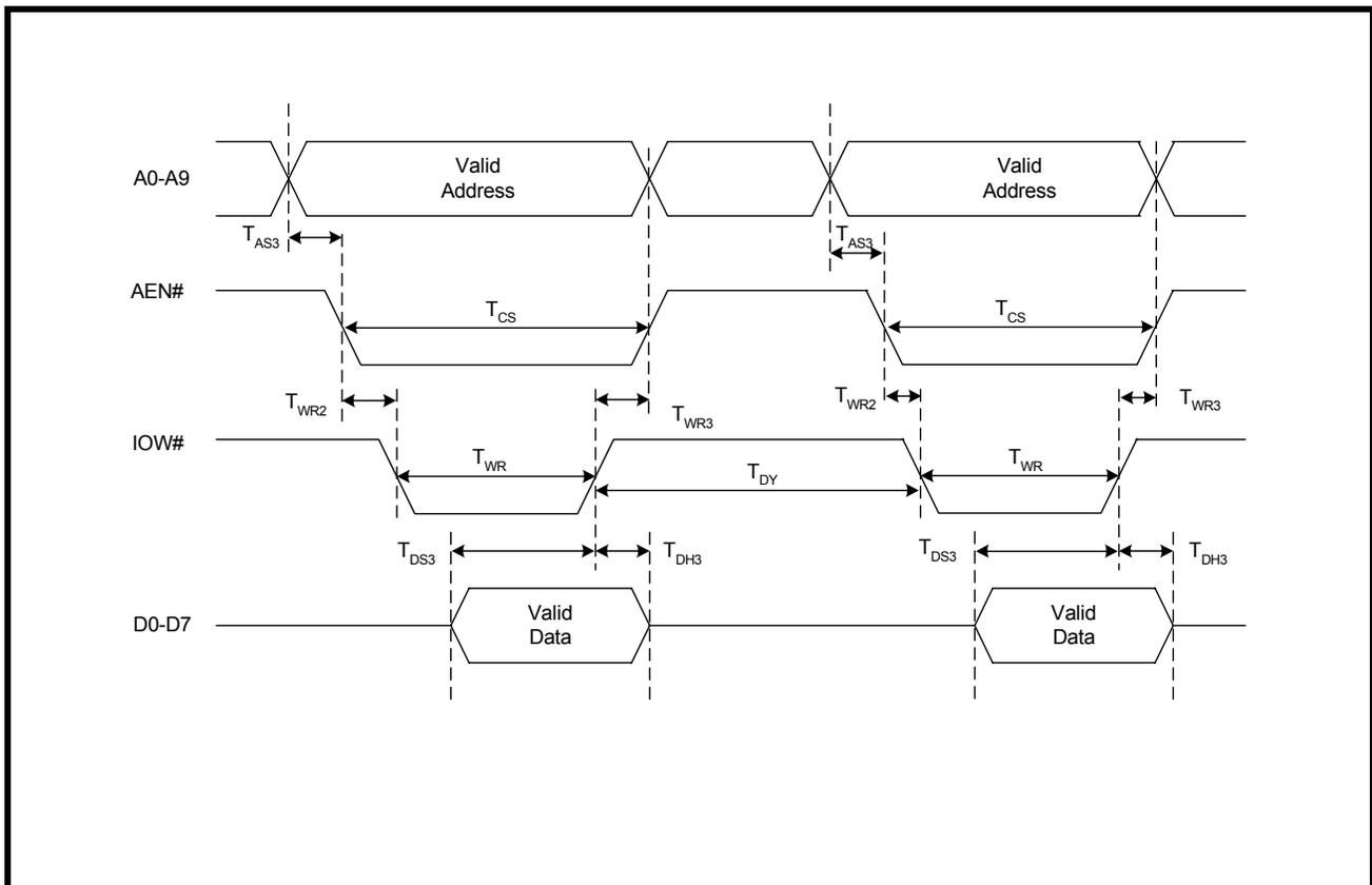
FIGURE 23. RECEIVE READY & INTERRUPT TIMING [NON-FIFO MODE]
